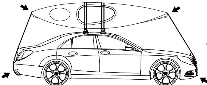
Une charge qui dépasse au-dessus du pare-brise (sauf une caisse de transport) doit obligatoirement être arrimée à l'avant et à l'arrière du véhicule, en plus du porte-bagage, sous peine de risquer de provoquer des dommages, des blessures ou même la mort.
